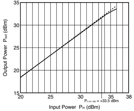
5.8 GHz OUTPUT POWER vs. INPUT POWER
