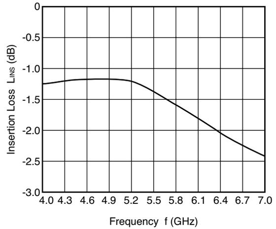
**TX-ANT2 INSERTION LOSS vs. FREQUENCY**
