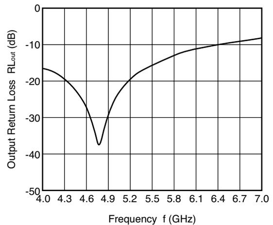
ANT1-RX INPUT RETURN LOSS vs. FREQUENCY
