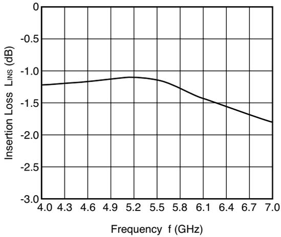
**ANT1-RX INSERTION LOSS vs. FREQUENCY**
