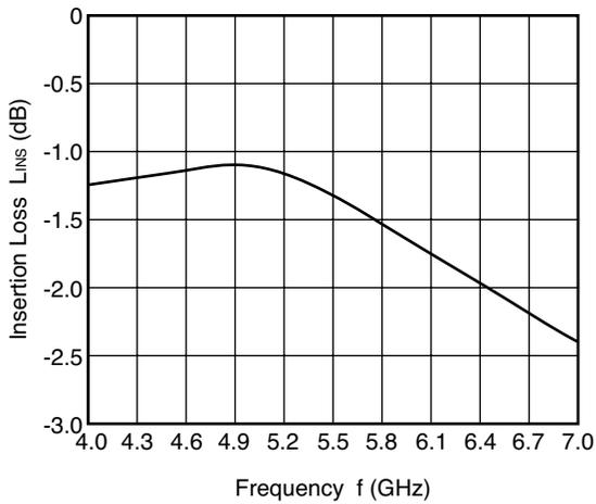
**ANT2-RX INSERTION LOSS vs. FREQUENCY**
