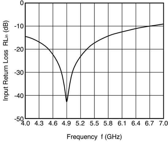
ANT2-RX OUTPUT RETURN LOSS vs. FREQUENCY
