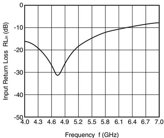
ANT1-RX OUTPUT RETURN LOSS vs. FREQUENCY
