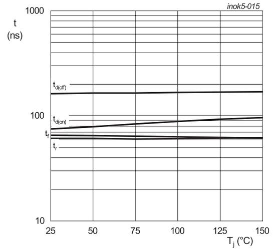
$I_C = 50 \text{ A}$ ;  $V_{GE} = 15V/0V$ ;  $R_g = 10 \Omega$ ;
