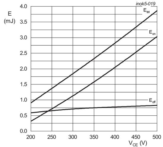
$I_C = 50 \text{ A}$ ;  $V_{CE} = 15\text{V}/0\text{V}$ ;  $T_j = 150 \text{ }^\circ\text{C}$ ;
