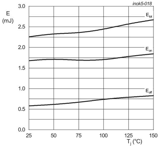
$I_C = 50 \text{ A}$ ;  $V_{CE} = 15\text{V}/0\text{V}$ ;  $R_g = 10 \text{ }\Omega$ ;
