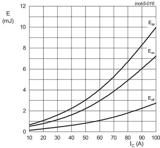
$R_g = 10 \Omega$ ;  $V_{GE} = 15V/0V$ ;  $T_j = 150 \text{ }^\circ\text{C}$ ;
