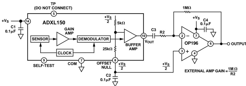
TYPICAL COMPONENT VALUES FOR AC COUPLED CIRCUIT
