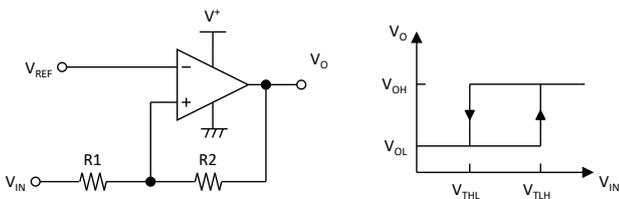
$$V_{TLH} = \frac{R1+R2}{R2} V_{REF} - \frac{R1}{R2} V_{OL}$$
