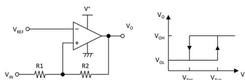
$$V_{TLH} = \frac{R1+R2}{R2} V_{REF} - \frac{R1}{R2} V_{OL}$$
