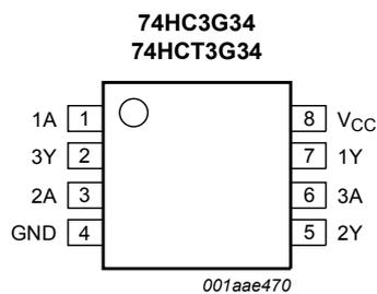
Figure 3. Pin configuration SOT505-2 (TSSOP8) and SOT765-1 (VSSOP8)
