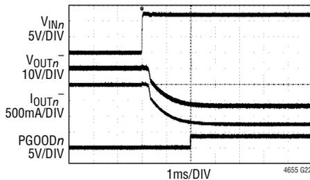
FIGURE 48 CIRCUIT, APPLICATION OF 12V<sub>IN</sub>,
