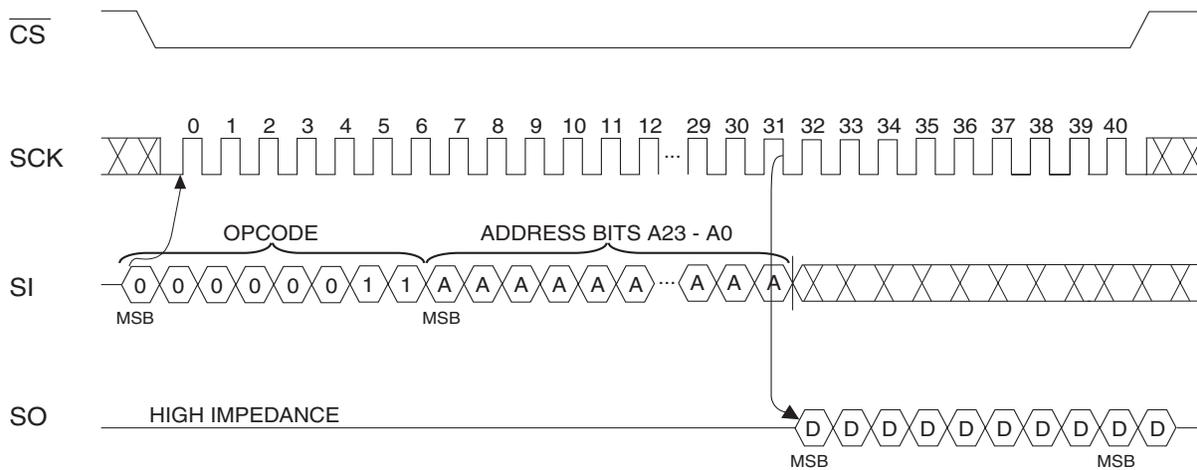
Figure 5-7. FAST READ Timing
