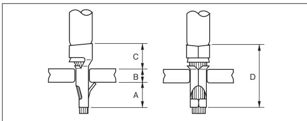
注) 基板穴寸法は基板の種類・材質・穴開け方法によって異なります。スルーホール基板などの固い素材の基板をご使用の場合は穴径を大きめに設定してください。上記の記載寸法は参考値ですので詳しくは弊社までお問い合わせください。
