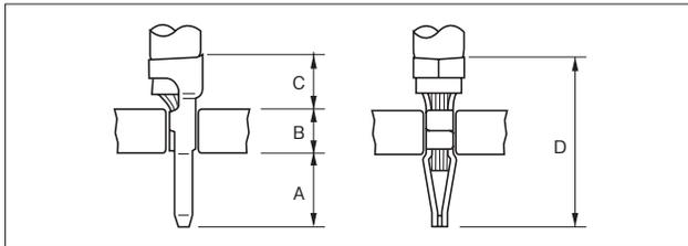
注) 基板穴寸法は基板の種類・材質・穴開け方法によって異なります。スルーホール基板などの固い素材の基板をご使用の場合は穴径を大きめに設定してください。上記の記載寸法は参考値ですので詳しくは弊社までお問い合わせください。
