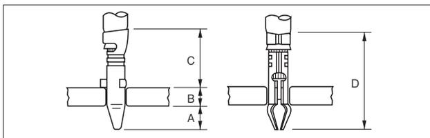
注) 基板穴寸法は基板の種類・材質・穴開け方法によって異なります。スルーホール基板などの固い素材の基板をご使用の場合は穴径を大きめに設定してください。上記の記載寸法は参考値ですので詳しくは弊社までお問い合わせください。
