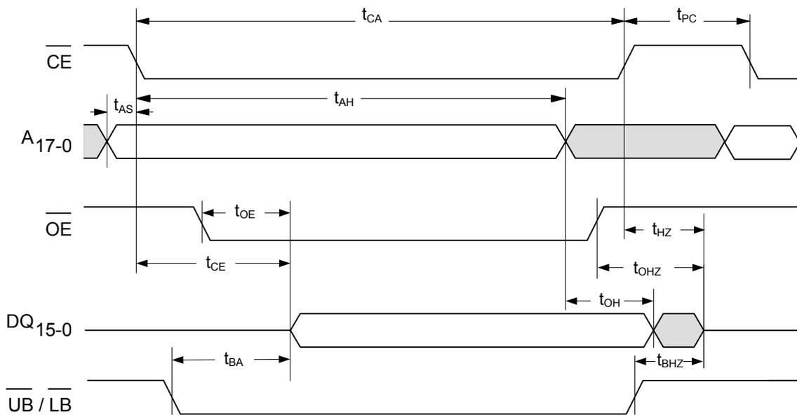
Figure 10. Page Mode Read Cycle Timing<sup>[9]</sup>
