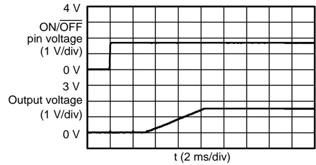
S-8533A33AFT ( $V_{IN} : 5.0\text{ V}$ )
