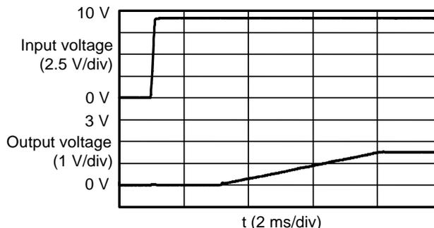
**S-8533A33AFT ( $V_{IN} : 0\text{ V} \rightarrow 5.0\text{ V}$ )**
