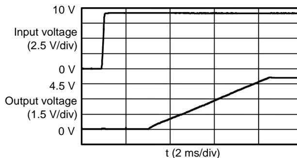
(2) ON/OFF Pin Response ( $V_{ON/OFF} : 0\text{ V} \rightarrow 1.8\text{ V}$ ,  $I_{OUT} : 10\text{ mA}$ )
