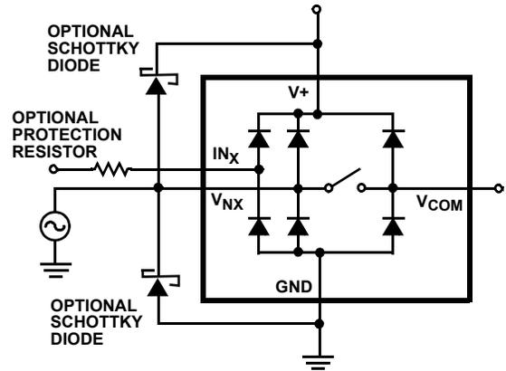
**FIGURE 9. OVERVOLTAGE PROTECTION**
