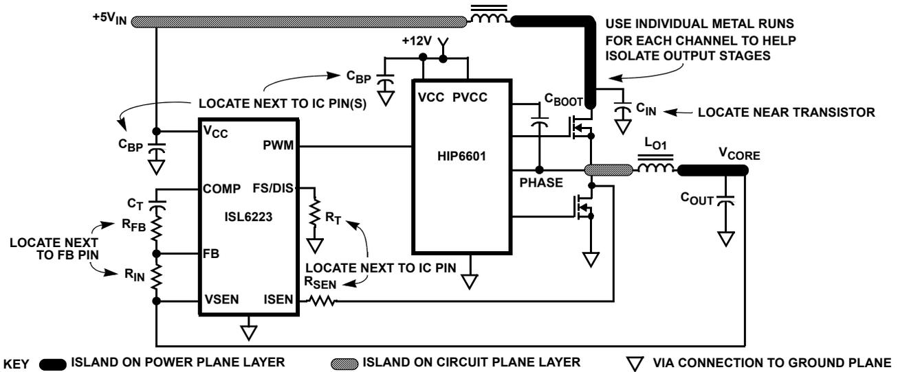
FIGURE 12. PRINTED CIRCUIT BOARD POWER PLANES AND ISLANDS
