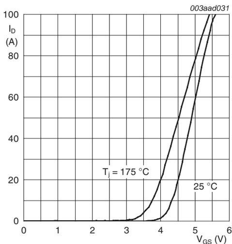
$T_j = 25\text{ °C}$ ;  $V_{DS} = 15\text{ V}$
