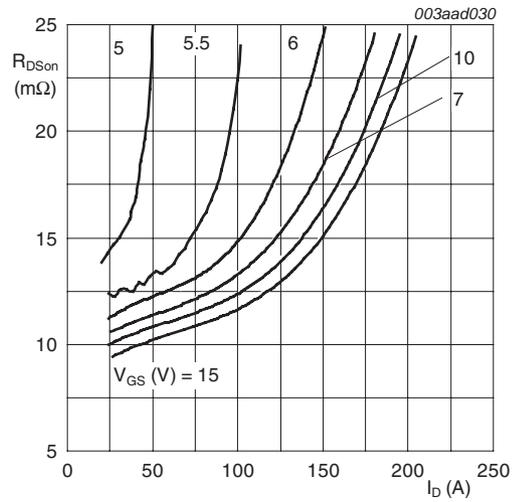
$T_j = 25\text{ °C}$ ;  $t_p = 300\mu\text{s}$
