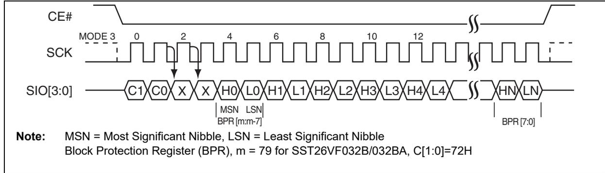
**FIGURE 5-37: READ BLOCK PROTECTION REGISTER SEQUENCE (SPI)**
