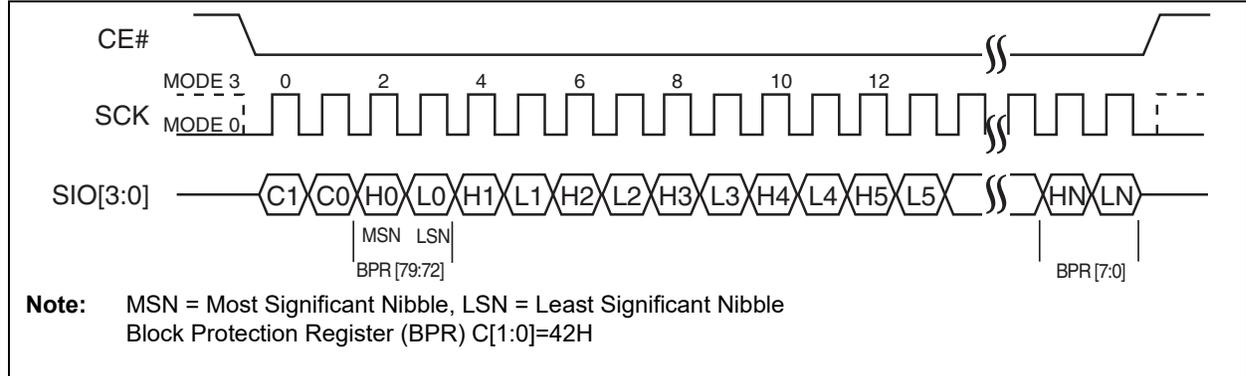
**FIGURE 5-39: WRITE BLOCK PROTECTION REGISTER SEQUENCE (SPI)**
