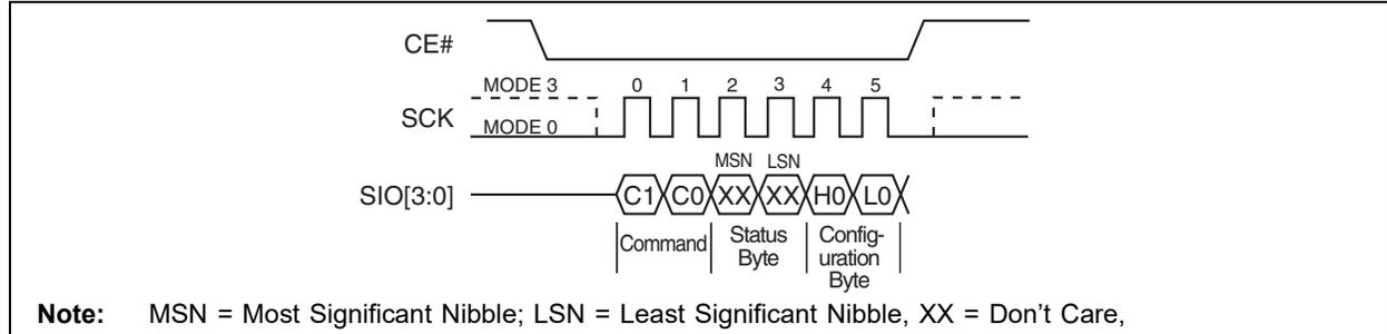
**FIGURE 5-31: WRITE STATUS REGISTER SEQUENCE (SPI)**
