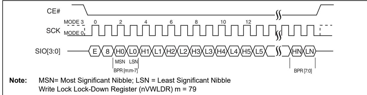
**FIGURE 5-43: WRITE LOCK LOCK-DOWN REGISTER SEQUENCE (SPI)**
