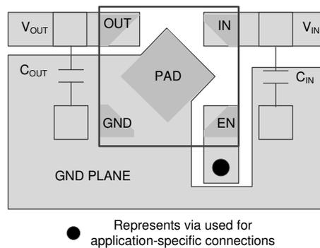
**Figure 37. Layout Example for the DQN Package**
