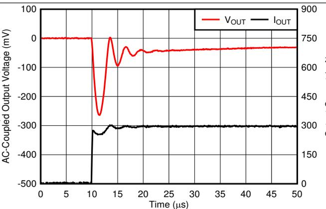
Figure 24. Load Transient
