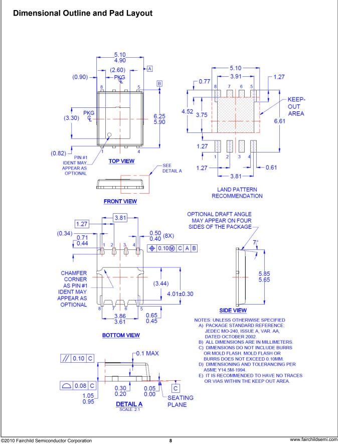
FDMS2506SDC N-Channel Dual Cool<sup>TM</sup> PowerTrench<sup>®</sup> SyncFET<sup>TM</sup>
