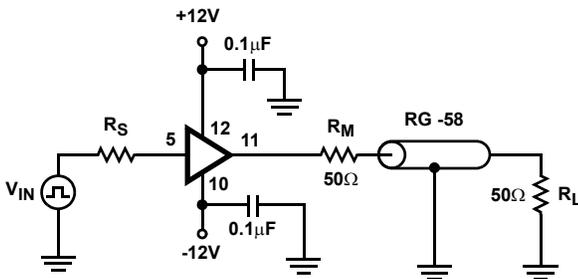
FIGURE 6. VIDEO COAXIAL LINE DRIVER 50Ω SYSTEM
