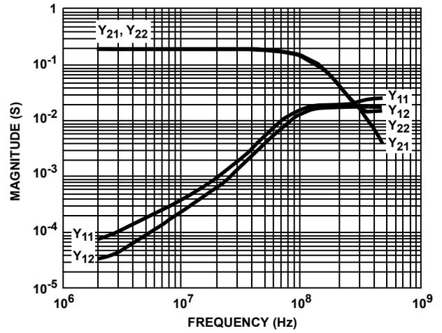
FIGURE 19. Y - PARAMETER MAGNITUDE vs FREQUENCY
