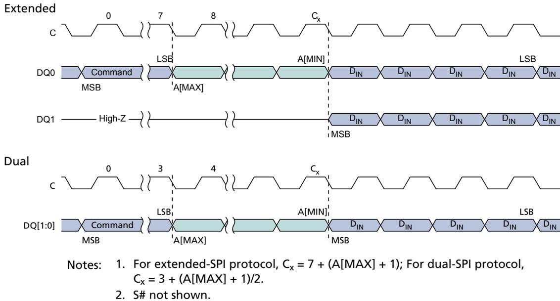
**Figure 37: EXTENDED DUAL INPUT FAST PROGRAM Command**
