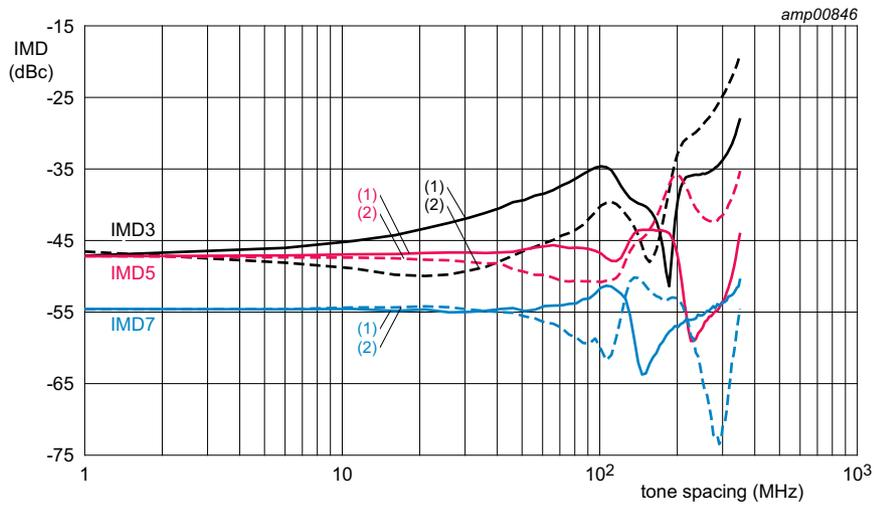
$T_{case} = 25\text{ }^{\circ}\text{C}$ ;  $V_{DS} = 28\text{ V}$ ;  $P_{L(AV)} = 3.16\text{ W}$ ;  $I_{Dq1} + I_{Dq2} = 222\text{ mA}$  (carrier and peaking stages);
