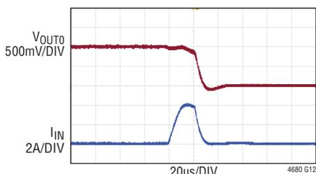
FIGURE 46 CIRCUIT, 12VIN, NO LOAD ON  $V_{\text{OUT}0}$  PRIOR TO APPLICATION OF SHORT-CIRCUIT USE HIGH RANGE OF  $I_{\text{LIMIT}}$  SYSTEM SHORT-CIRCUIT USING LOW IMPEDANCE COPPER ACROSS OUTPUT (HARD SHORT)
