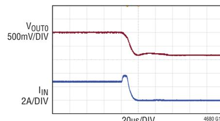
FIGURE 46 CIRCUIT, 12VIN, 30A LOAD ON  $V_{\text{OUT}0}$  PRIOR TO APPLICATION OF SHORT-CIRCUIT USE HIGH RANGE OF  $I_{\text{LIMIT}}$  SYSTEM SHORT-CIRCUIT USING LOW IMPEDANCE COPPER ACROSS OUTPUT (HARD SHORT)
