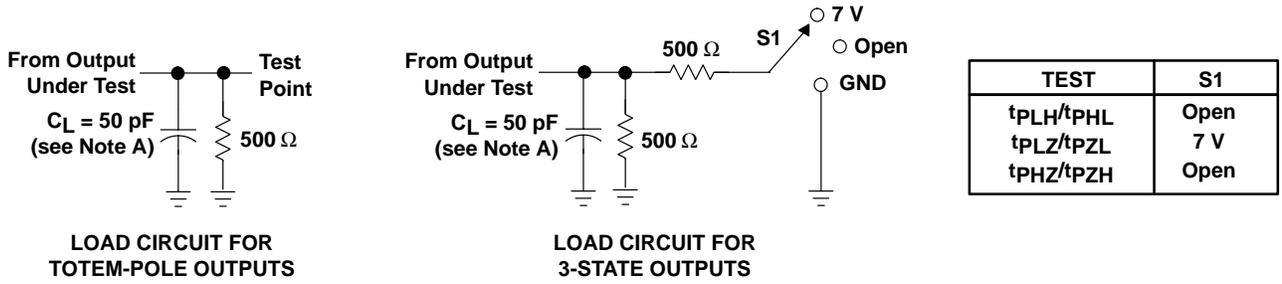
**LOAD CIRCUIT FOR TOTEM-POLE OUTPUTS**
