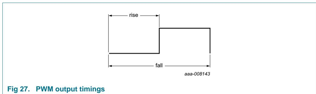
**Fig 27. PWM output timings**
