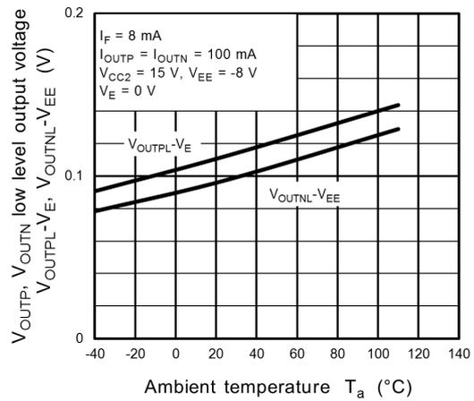
Fig. 13.3.16  $V_{OUTPL} - V_E, V_{OUTNL} - V_{EE} - T_a$
