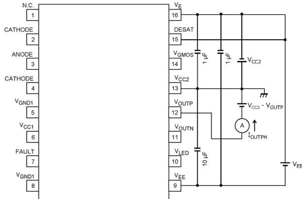
Fig. 13.1.1 I<sub>OUTPH</sub> Test Circuit
