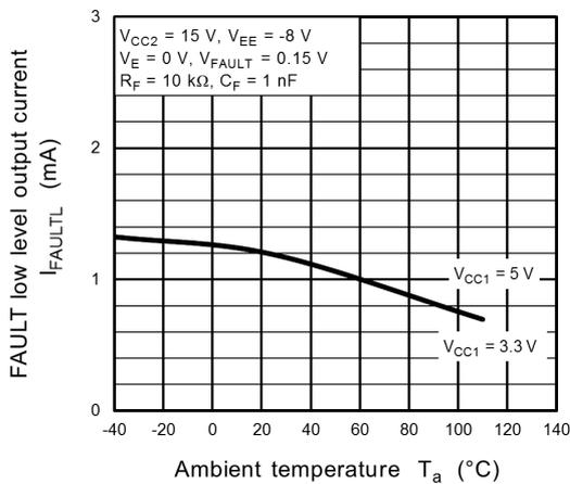
**Fig. 13.3.27**  $I_{FAULTL} - T_a$
