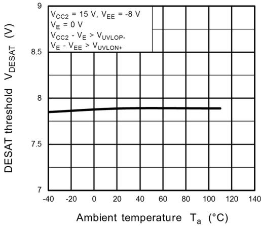
**Fig. 13.3.25**  $V_{DESAT} - T_a$
