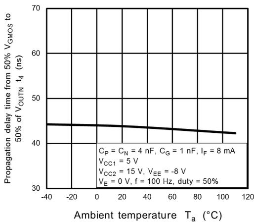
**Fig. 13.3.33  $t_4 - T_a$**
