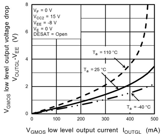
**Fig. 13.3.12**  $(V_{OUTGL} - V_{EE}) - I_{OUTGL}$
