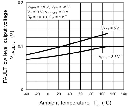
**Fig. 13.3.26**  $V_{FAULTL} - T_a$
