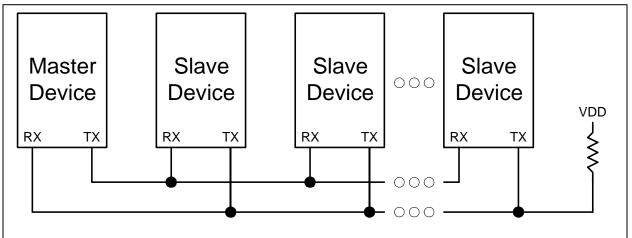
Figure 18.7. UART Multi-Processor Mode Interconnect Diagram
