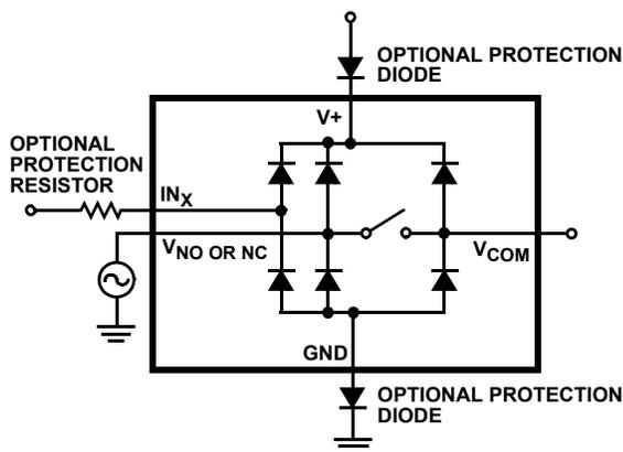
FIGURE 8. OVERVOLTAGE PROTECTION
