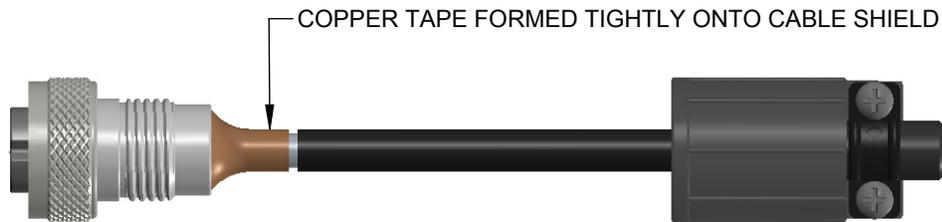
**STEP 6:** SLIDE INSULATOR WITH THE COPPER TAPE INTO THE BACK OF THE PLUG HOUSING. FORM FREE END OF COPPER TAPE TIGHTLY ONTO THE SHIELD OF THE CABLE. MAKE CERTAIN NEITHER THE COPPER TAPE NOR THE CABLE SHIELDING TOUCH ANY OF THE TERMINALS.
