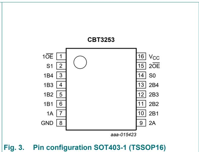
Fig. 3. Pin configuration SOT403-1 (TSSOP16)
