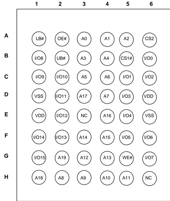
**48-Pin mini BGA, 1 Chip Select, A19 on H6 (B3), 48-Pin mini BGA, 2 Chip Select, A19 on H6 (B4)**
