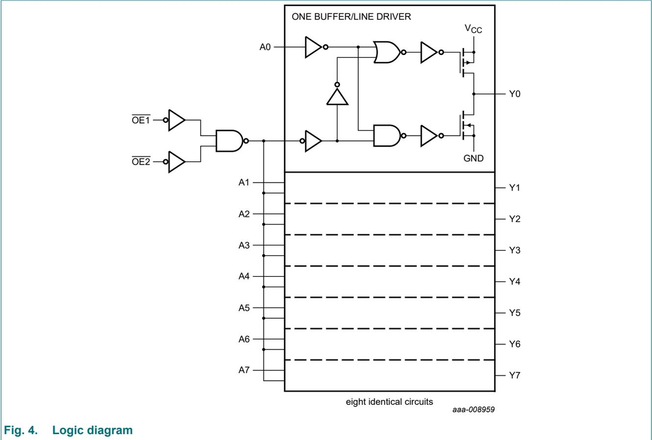
Fig. 4. Logic diagram
