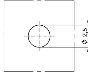
Mounting Hole  $\phi 2,5\text{mm}$
