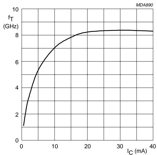
$V_{CE} = 6$  V;  $f = 1$  GHz;  $T_{amb} = 25$  °C.
