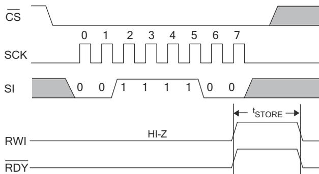
Figure 25. Software RECALL Cycle<sup>[19]</sup>
