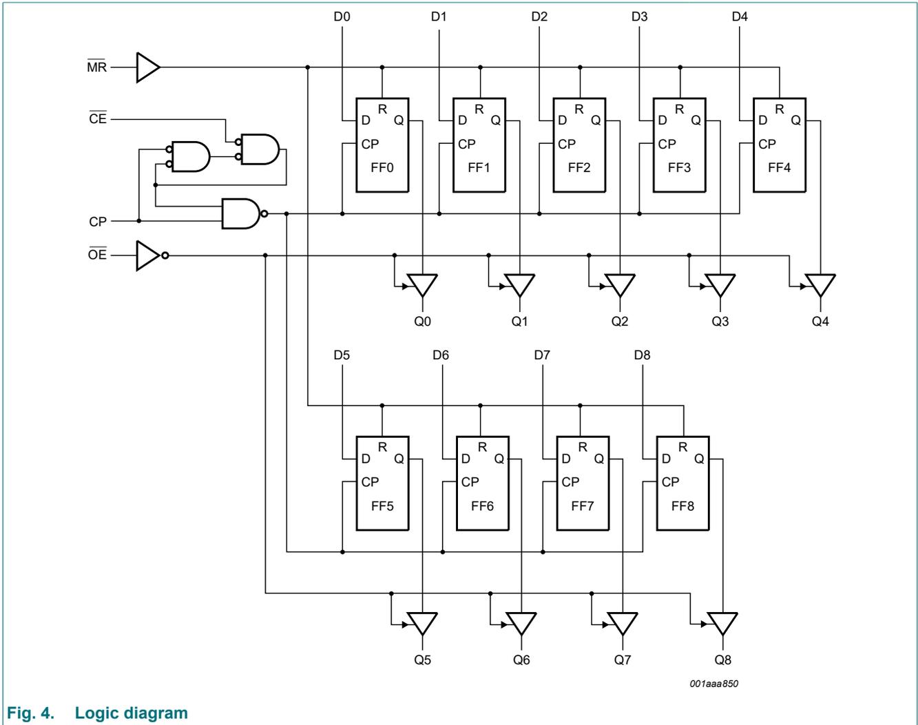
Fig. 4. Logic diagram
