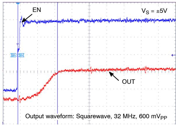
**Figure 24. Turn OFF Time Delay**
