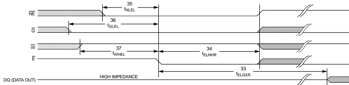
RECALL CYCLE #3:  $\overline{G}$  Controlled<sup>o, r</sup>
