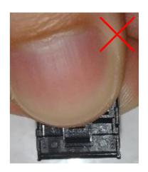
コネクタの嵌合を取り外す際は、必ずロック解除を実施して下さい。 Please be sure to release the lock when unmating the connector.
