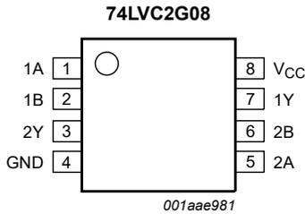
Fig. 4. Pin configuration SOT505-2 (TSSOP8) and SOT765-1 (VSSOP8)
