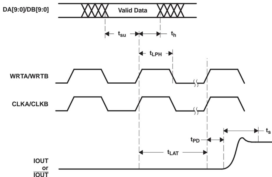
**Figure 16. Dual-Bus-Mode Operation**
