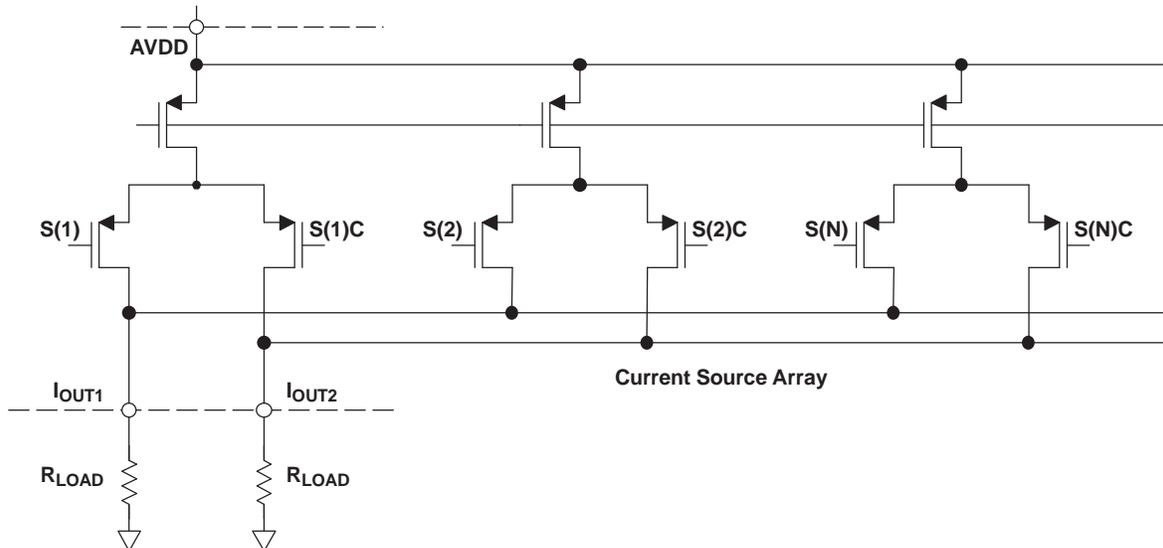
**Figure 18. Analog Outputs**
