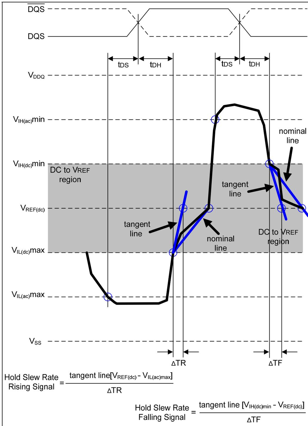
Figure 27 —Illustration tangent line for t<sub>DH</sub> (differential DQS,  $\overline{\text{DQS}}$ )
