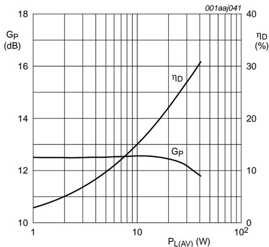
$V_{DS} = 28\text{ V}$ ;  $I_{DQ} = 1050\text{ mA}$ ;  $f = 3500\text{ MHz}$ ;
