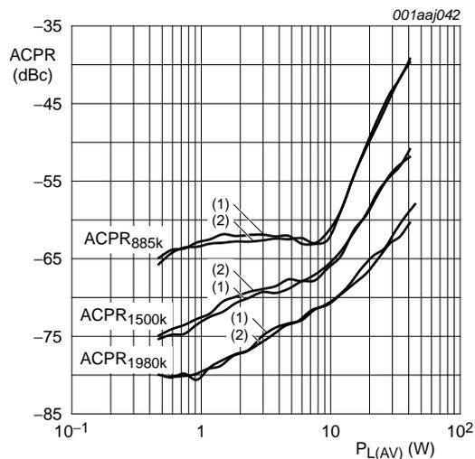
$V_{DS} = 28\text{ V}$ ;  $I_{DQ} = 1050\text{ mA}$ ;  $f = 3500\text{ MHz}$ ;
