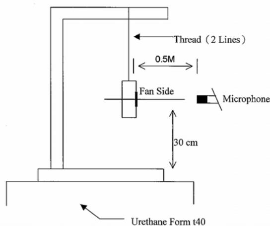
0.5 METER FROM MICROPHONE TO FAN INTAKE
