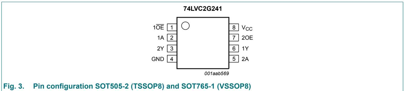
Fig. 3. Pin configuration SOT505-2 (TSSOP8) and SOT765-1 (VSSOP8)
