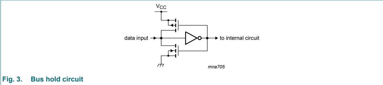
Fig. 3. Bus hold circuit
