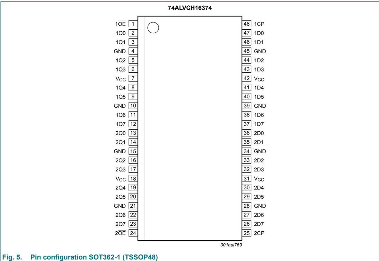
Fig. 5. Pin configuration SOT362-1 (TSSOP48)
