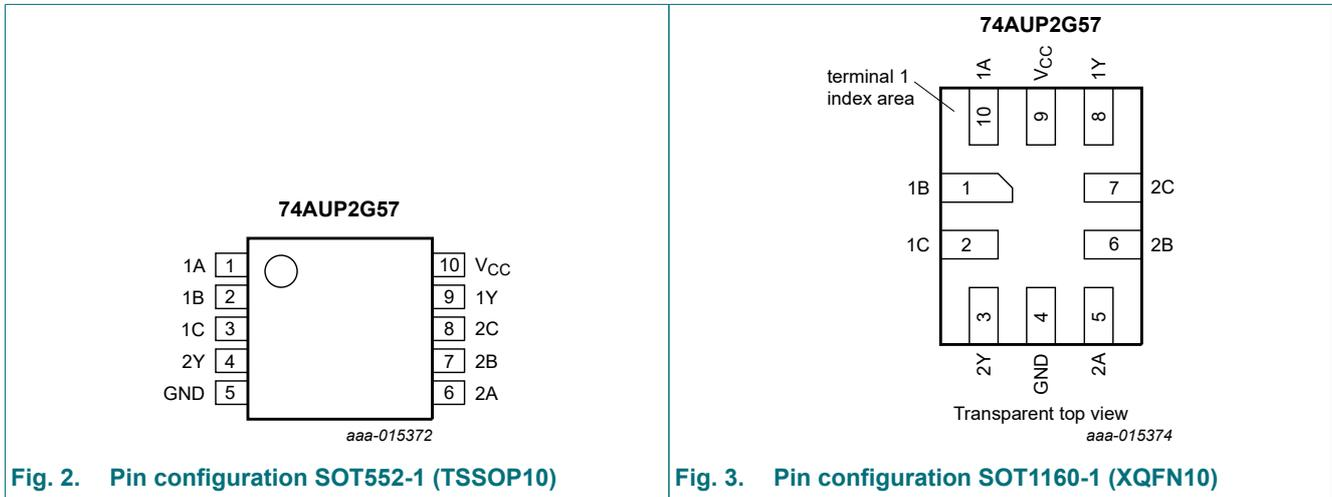
Fig. 2. Pin configuration SOT552-1 (TSSOP10)
