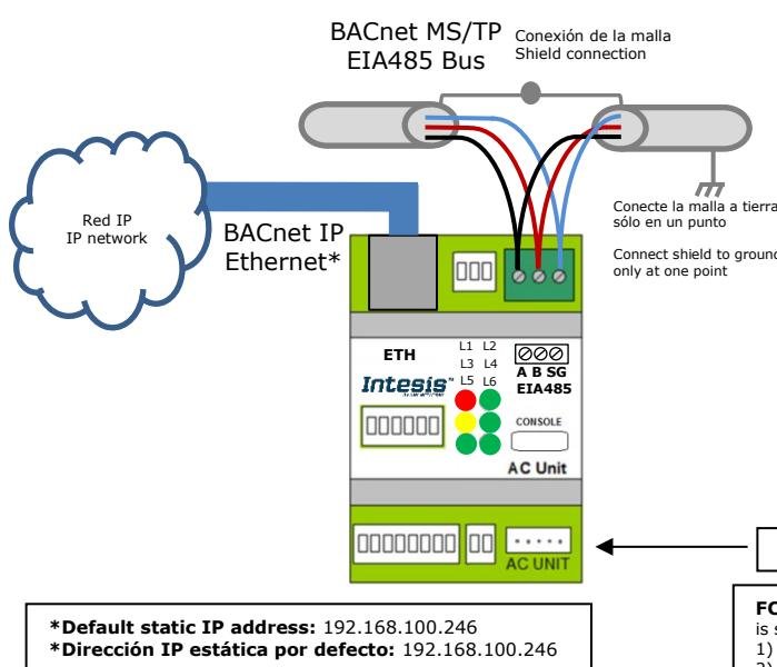
**IMPORTANTE:** La ampliación o acortamiento del cable de conexión que se incluye con el interfaz puede provocar un funcionamiento incorrecto. Mantenga el cable de conexión lo más alejado posible del cableado eléctrico y del cable de tierra, no los enrolle juntos.
