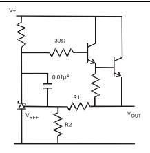
$$V_{OUT} = \left(1 + \frac{R1}{R2}\right) V_{REF}$$
