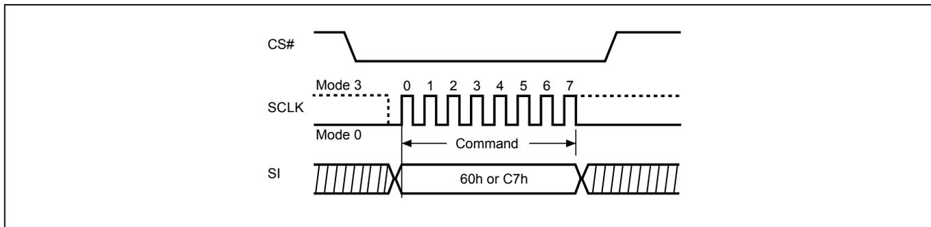
**Figure 46. Chip Erase (CE) Sequence (QPI Mode)**
