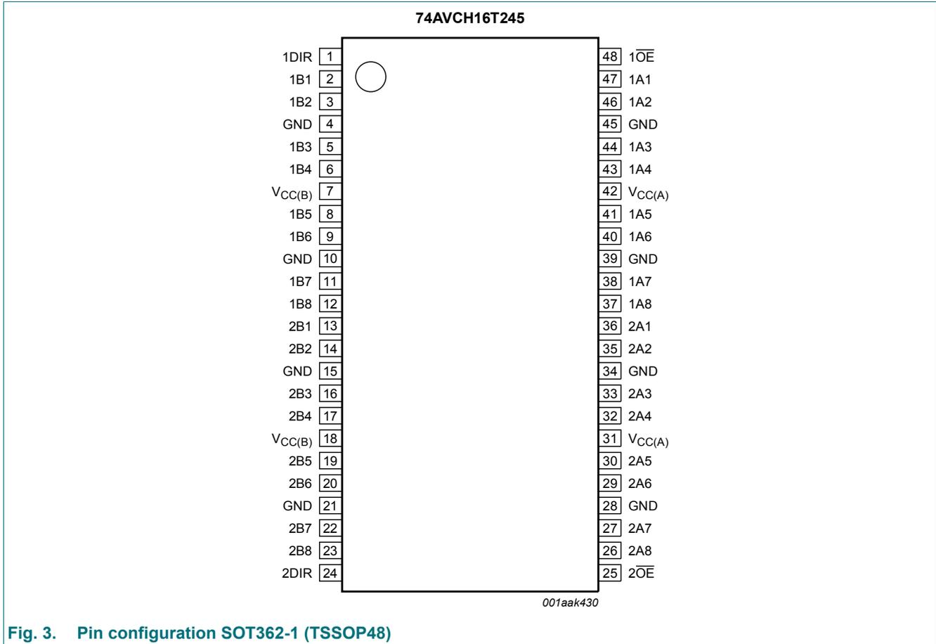
Fig. 3. Pin configuration SOT362-1 (TSSOP48)
