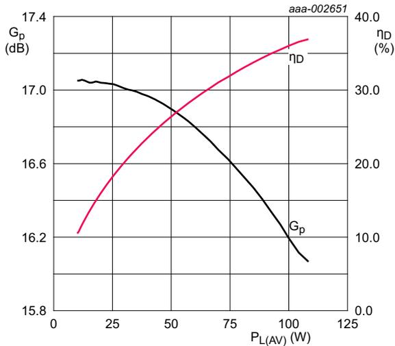
$V_{DS} = 32\text{ V}$ ;  $I_{Dq} = 1700\text{ mA}$ ;  $f = 2650\text{ MHz}$ ;
