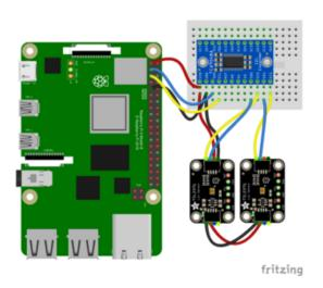
Pi 3V to mux VIN (red wire)
