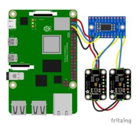
Pi 3V to mux VIN (red wire)
